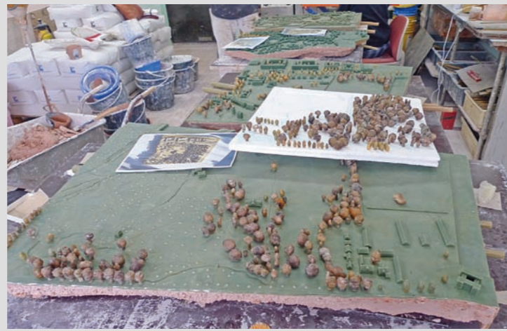
WACHSMODELLTEILE MIT ANGUSSSYSTEM GIPS-SCHAMOTTE AUFTRAG
