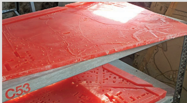
POSITIVFORM - SILIKON NEGATIVFORM - WACHSMODELLE
