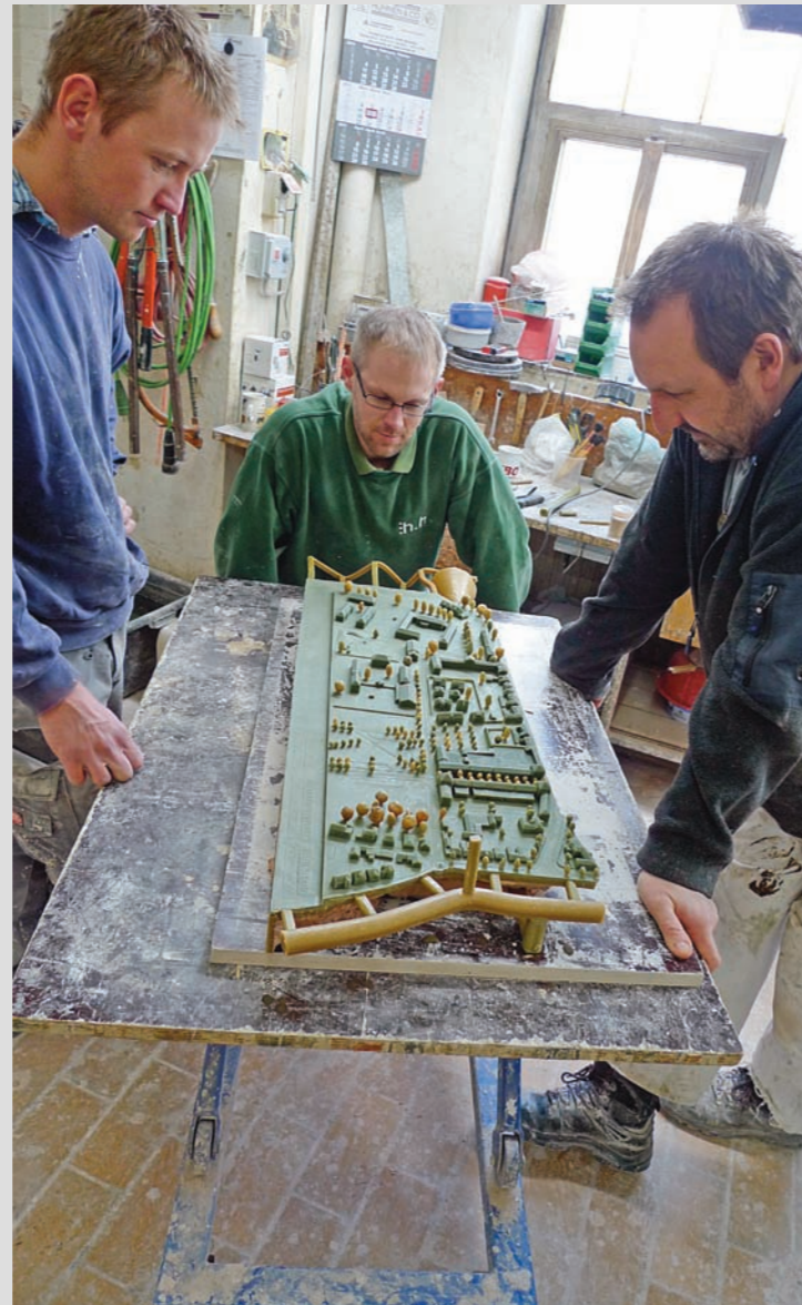
WACHSMODELLTEILE MIT ANGUSSSYSTEM GIPS-SCHAMOTTE AUFTRAG
